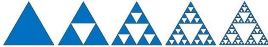
Figura 3: Procedimento iterativo per generare il triangolo di Sierpinski.
