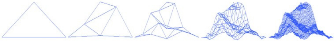
Figura 6: Esempio di procedimento iterativo usato per generare sfondi montani realistici
