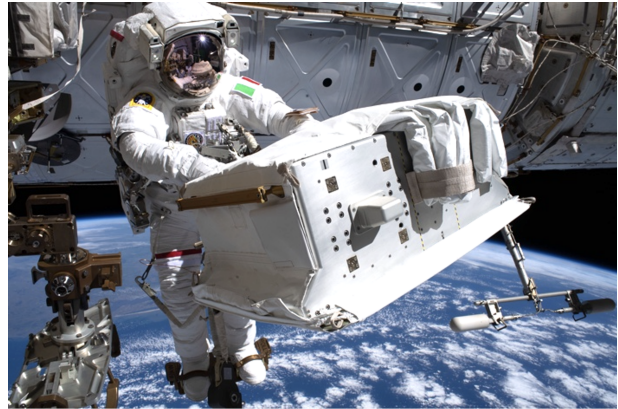
Figura 6: Dicembre 2019 - gennaio 2020: nel corso di una serie di quattro storiche EVA Luca Parmitano (ESA) e Drew Morgan (NASA) sostituiscono il cuore del sistema di raffreddamento del tracciatore al silicio di AMS-02, garantendo all'esperimento altri 10 anni di vita.
