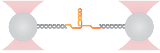
Figura 1: Schema della manipolazione di una forcina di DNA tramite pinzette ottiche (non in scala). I capi della forcina di DNA sono fissati a due catene di DNA, ciascuna delle quali è fissata a una perla su cui agisce un fascio laser. Le perle sono attratte verso il centro del fascio laser da una forza approssimativamente armonica. Manovrando i fasci laser è possibile avvicinare o allontanare le perle, compiendo così del lavoro sulla forcina.
