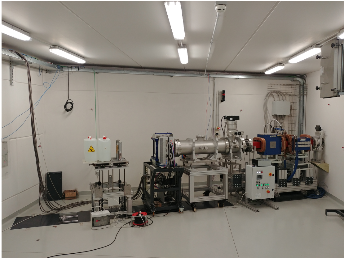
Figura 11: La linea di fascio dedicata alla ricerca al CNAO: qui è presentata la fase finale delle procedure di test all'interno della sala sperimentale. The CNAO experimental beam line in the last phase of the commissioning in the experimental room.
