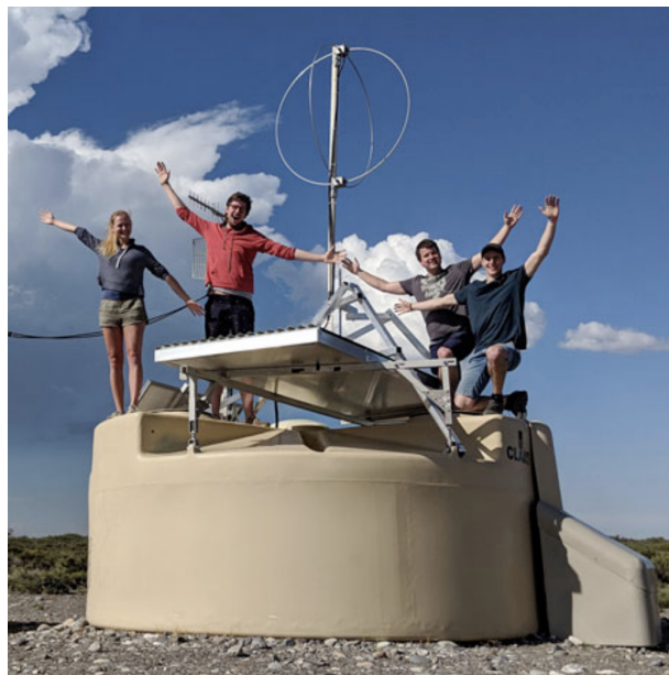
Figura 15: Uno dei rivelatori di superficie di AugerPrime. Sono visibili sia il rivelatore a scintillazione (4 m 2 ) che l'antenna radio installati sopra la stazione Čerenkov.
