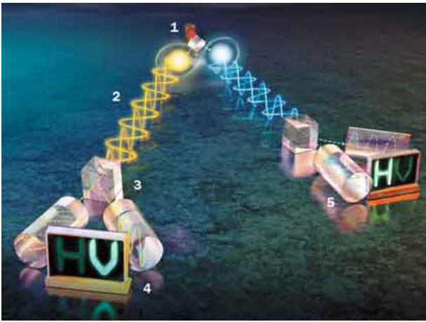
Figura 8: Un laser (1) emette una coppia di fotoni (2), schematizzati con le due onde elettromagnetiche azzurra e gialla, che si trovano in stato entangled . Essi incidono su un rivelatore di stato (ad esempio la polarizzazione) (3) connesso con un contatore (4). Esperimenti di questo tipo mostrano che i fotoni scambiano informazione sul proprio stato all'istante, indipendentemente dalle distanze coinvolte. Sebbene la relatività non venga violata in quanto l'analisi delle coincidenze può essere realizzata solo mediante un canale classico, vincolato al limite della velocità della luce, la concezione classica dello spazio viene ovviamente alterata.
