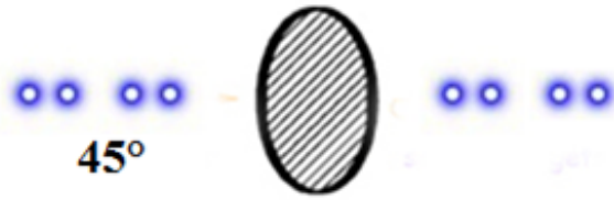
Figura 29: Esperimento di polarizzazione di fotoni polarizzati a 45^\circ attraverso un polarizzatore a 45^\circ . Passano tutti i fotoni.
