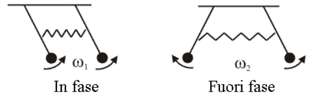
Figura 7: Oscillazioni naturali di due pendoli accoppiati in fase e fuori fase. Le frequenze delle oscillazioni sono diverse da quella del singolo pendolo e la differenza tra le due è proporzionale al grado di accoppiamento.
