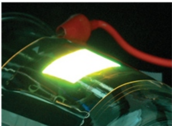
Figura 7: Prototipo di display a colori basato sulla combinazione di Qdots di diversi colori e transistor a film sottili di ossido di Hf, In e Zn.
