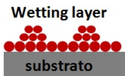
Figura 6: Possibili deposizioni eterogenee di un secondo materiale (in rosso) su un materiale preesistente (substrato, in grigio). Il modello Frank van der Merwe prevede una crescita per strati atomici successivi che si manifestano in terrazzamenti sulla superficie. Il modello Volmer-Weber, caratterizzato dalla non bagnabilità del substrato da parte dello strato depositato, evolve a isole, come delle gocce d'acqua su una superficie. L'ultimo regime è quello Stranski-Krastanov, dove lo strato dapprima bagna il substrato crescendo in modo planare e poi evolve in una nanostruttura tridimensionale a causa dell'elevata energia interna accumulata. In alto a destra si può vedere il sistema di Epitassia da Fascio Molecolare dei laboratori CNR-Nanotec, mentre in basso a destra un'immagine di un quantum dot di InAs in matrice di GaAs acquisita in sezione con un microscopio elettronico a trasmissione ad alta risoluzione.
